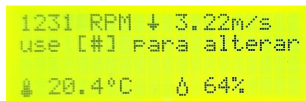
Figura 7 – Tela do equipamento em operação (está funcionando a 1231 R.P.M., de cima para baixo (visto de frente, pelo lado da agulha injetora de material) equivalente a 3,22 metros por segundo e a temperatura do ar é de 20,4°C e a umidade é de 64%.
