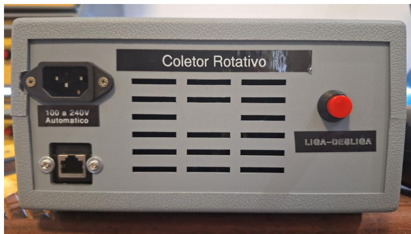
Figura 3 – Conexão da alimentação e do controle para unidade mecânica no Painel traseiro
