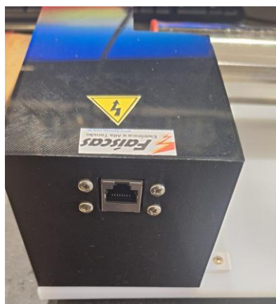
Figura 6 – Conector multipolo do cabo de ligação que conecta a unidade mecânica à unidade de controle
